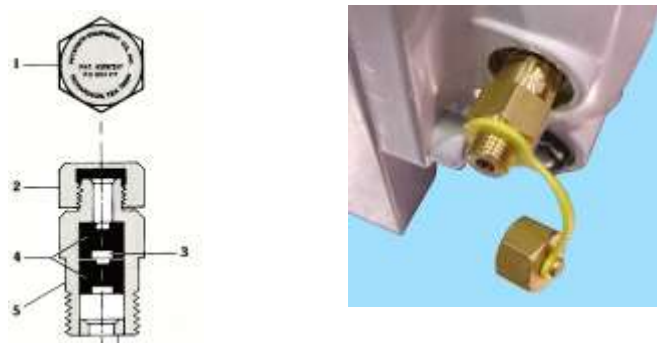
1 - Этикетка; 2 - Колпачок с прокладкой; 3 - Карман; 4 - Самозакрывающийся клапан; 5 - Корпус
